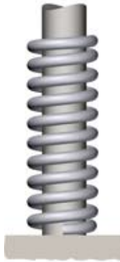
2. Не плоская снизу с внутренней направляющей
