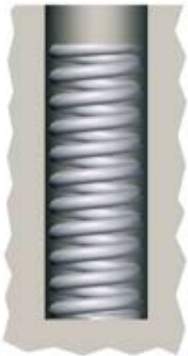
1. С опорным витком в наружной направляющей
