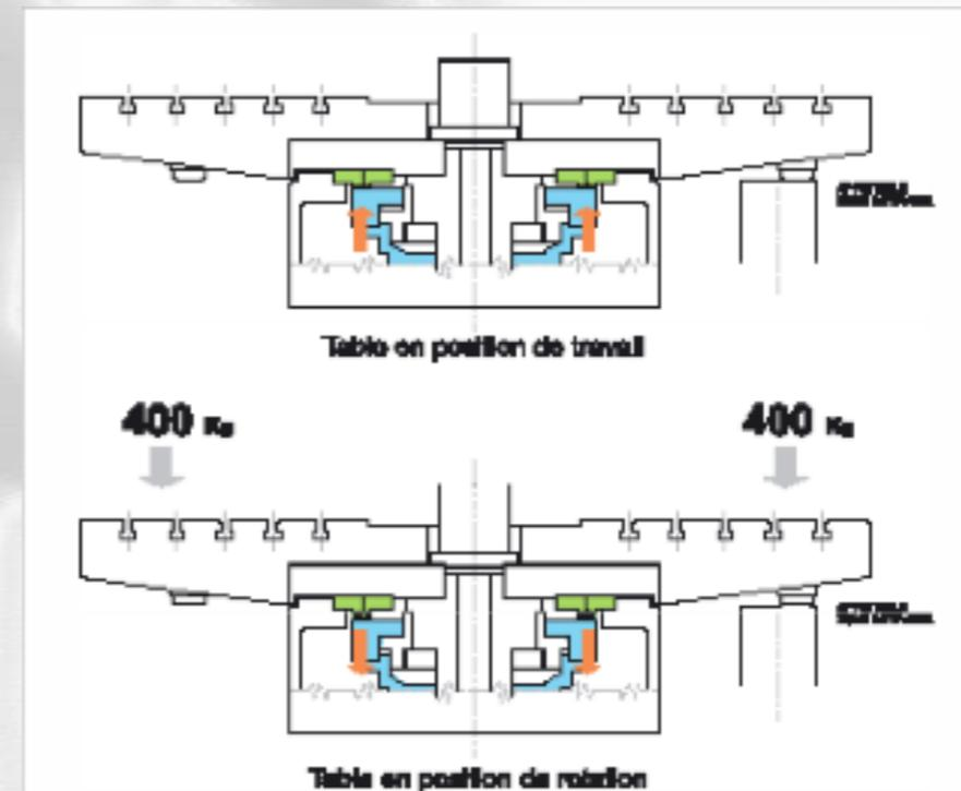
Система Rotorallet оборудуется тройным зубчатым венцом с V-образным зацеплением, которое при движении вниз разблокирует стол
