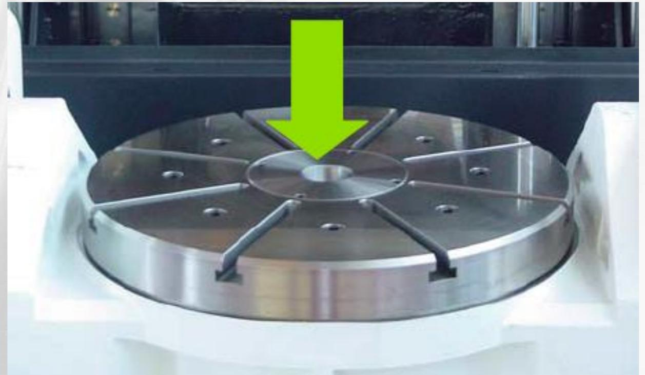
Наш наклонно-поворотный стол оборудуется гидро-пневматическим поворотным сочленением для установки оборудования, зажимающего и разжимающего обрабатываемые детали (гидравлический узел в комплект поставки не входит).
