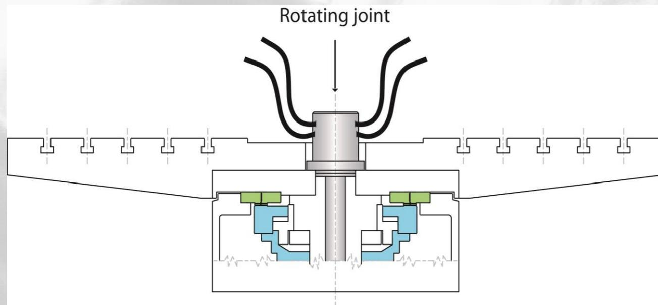
Поворотное сочленение с 4 выпускными отверстиями (гидравлика и пневматика) для установки оборудования, зажимающего и разжимающего обрабатываемых деталей (гидравлический узел в комплект не входит).
