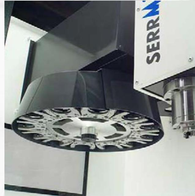
Инструментальный магазин на 12 позиций инструментов (автоматическая смена инструмента)
