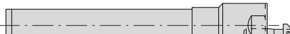
Kerbzahnkörper Werkzeugstahl Serrated tool bodies in tool steel Удлинитель, закаленная инструментальная сталь Ø 20 – 34 mm
